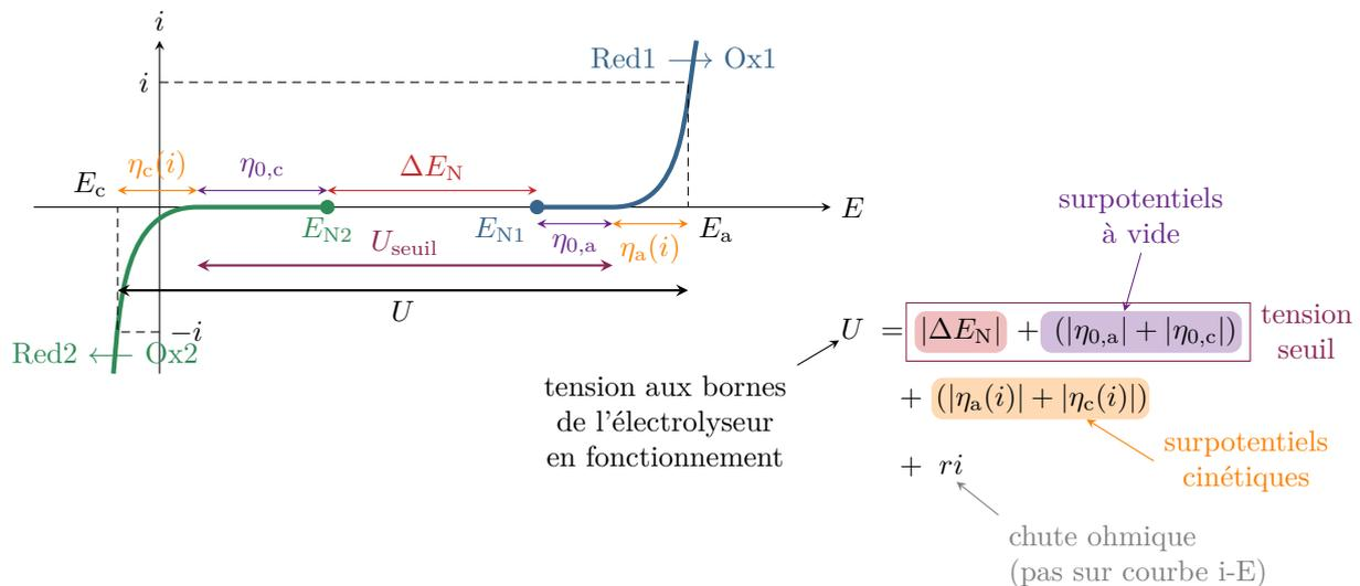
▷ Électroneutralité  $\implies$  même courant dans l'anode et la cathode.
