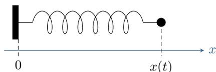
On considère un oscillateur masse-ressort horizontal. Le solide attaché à l'extrémité du ressort est modélisé par un point matériel de masse  $m$ . Sa position  $x$  est repérée le long d'un axe horizontal orienté comme sur la figure ci-dessous.
