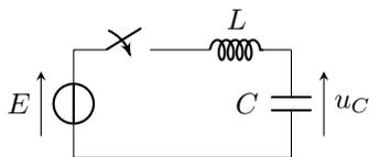
Établir l'équation différentielle vérifiée par la tension  $u_C$  après la fermeture de l'interrupteur à  $t = 0$ . L'écrire sous forme canonique et identifier la pulsation propre du circuit.
