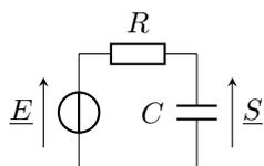
Considérons le circuit ci-contre, où la sortie est la tension aux bornes du condensateur.
