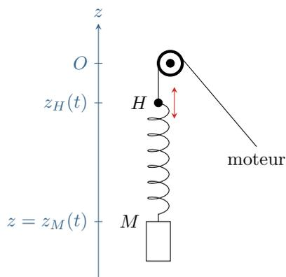
Un système de moteur et de poulie permet de faire osciller de façon harmonique le point d'attache du ressort,
