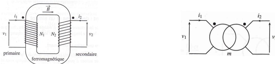
**Figure 2 – Schéma réel et normalisé d'un transformateur.** Sur ce schéma, les courants au primaire et au secondaire entrent par des bornes homologues.
