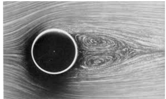
*Écoulement présentant une zone turbulente*
