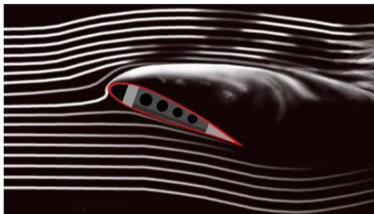
La photo ci-contre représente les lignes de courant d'un écoulement autour d'une profil type aile d'avion, visualisées par injection de fumée dans un écoulement d'air en soufflerie et photographie avec temps de pose long.
