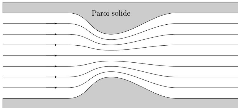
**Expérimentalement :** Dans un écoulement permanent, les lignes de courant sont confondues avec les trajectoires des particules fluides, ce qui permet de les visualiser de façon raisonnablement simple en utilisant des traceurs, petites particules injectées dans l'écoulement (fumée, colorant, micro-billes opaques, etc.). C'est plus délicat pour les écoulements non stationnaires.
