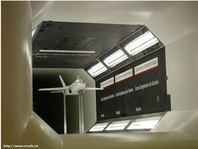
Figure 3 – Essai aérodynamique d'un avion à réaction.
