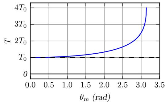
Figure 2 – Période des oscillations du pendule simple en fonction de leur amplitude.
