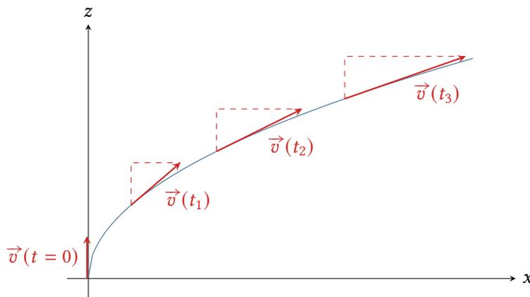
**Figure 3 – Trajectoire du ballon sonde.** Les traits pointillés indiquent la construction du vecteur vitesse.
