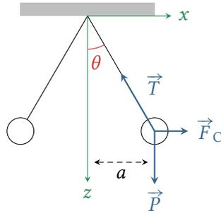
Figure 2 – Pendule électrostatique.
