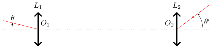
Figure 2 – Schéma de principe pour la formation de l'image.
