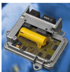
Figure 2 – Détecteur de choc. Gauche : photo du détecteur sur son circuit électrique. Droite : schéma vu en coupe, les points représentent les spires du ressort.
