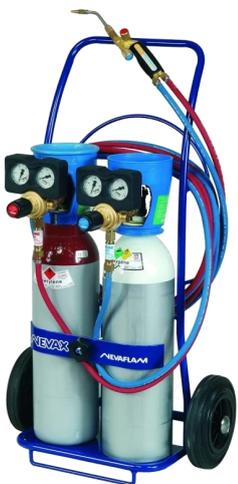
Un chalumeau est un outil employé pour la découpe ou la soudure thermique de pièces de métal. La source de chaleur est obtenue par la combustion d'un mélange de gaz. Dans le cas d'un chalumeau oxyacétylénique, le gaz utilisé est l'acétylène  $\text{C}_2\text{H}_2$ , dont la combustion dégage une énergie importante du fait de la triple liaison carbone-carbone et de l'efficacité de l'oxycombustion. La température de la flamme ainsi produite peut dépasser  $3000^\circ\text{C}$ .
