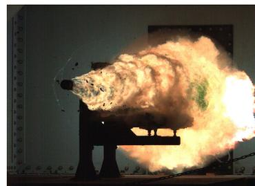
**Figure 3 – Rail-gun.** Gauche : schéma de principe. Droite : photo prise lors d'un essai d'un rail gun de la Navy américaine.
