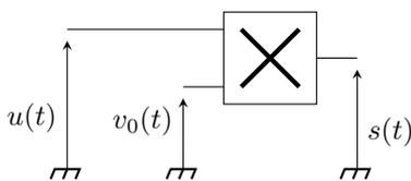
Avec un générateur, on crée un signal de référence  $v_0$  dont la fréquence  $f_0$  connue est intermédiaire entre  $f$  et  $f + \Delta f$ . Ce signal de référence et la tension amplifiée  $u(t)$  sont envoyées en entrée d'un multiplieur analogique de gain  $k$ , qui délivre la tension de sortie
