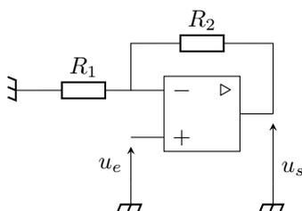
La tension délivrée par le micro est d'amplitude trop faible pour être directement exploitable à l'oscilloscope : il est nécessaire de l'amplifier. On utilise pour cela le montage ci-contre.
