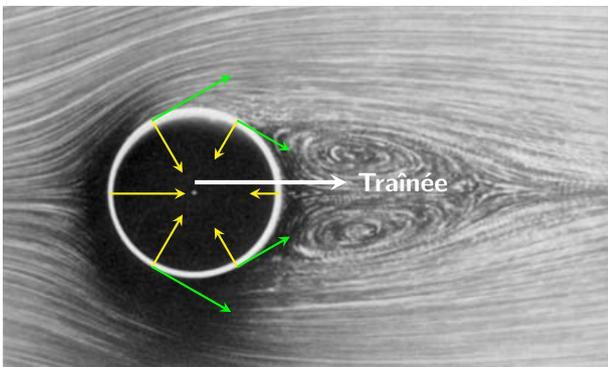
La force de traînée exercée par un fluide sur un solide en mouvement est, par définition, la composante de la force totale parallèle au vecteur vitesse. Il s'agit de la résultante des forces de viscosité (forces tangentielles) et des forces de pression dynamique (forces normales) subies par le solide, projetée dans la direction du mouvement, comme schématisé ci-contre. Dans le cas général, la force de traînée s'exprime sous la forme
