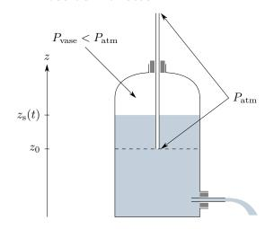
Un vase de Mariotte est un récipient fermé dans lequel on fait pénétrer un tube relié à l'air libre. L'originalité du dispositif tient au fait que la pression atmosphérique n'est pas imposée au niveau de la surface libre de l'eau, mais au niveau du bas du petit tube. En intégrant la relation de la statique des fluides, on constate alors que le profil de pression hydrostatique dans l'eau est alors indépendant de la position de la surface libre, donné par
