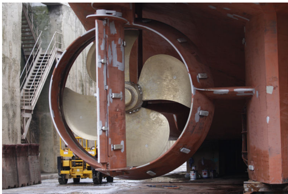
Figure 6 – Protection d'un bateau par anode sacrificielle. Gauche : on distingue plusieurs anodes sacrificielles sur le tour de l'hélice et du gouvernail. Droite : photo d'une anode sacrificielle usagée.
