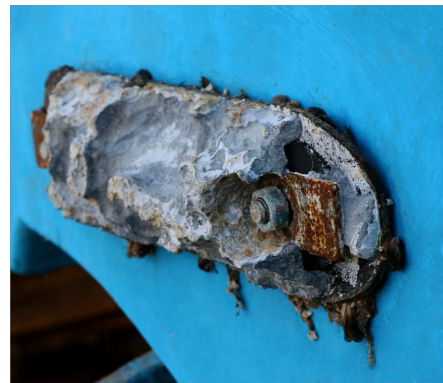
Figure 6 – Protection d'un bateau par anode sacrificielle. Gauche : on distingue plusieurs anodes sacrificielles sur le tour de l'hélice et du gouvernail. Droite : photo d'une anode sacrificielle usagée.
