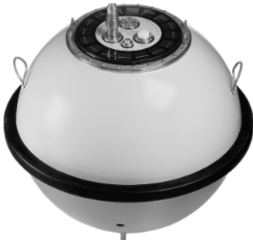
Figure 1 Photographies d'une bouée houlographe Waverider
