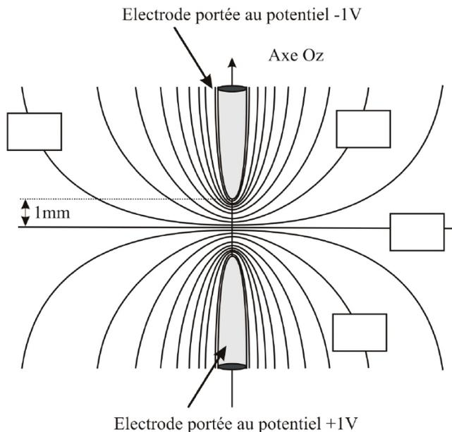
On s'intéresse maintenant à deux électrodes paraboliques. Un logiciel de simulation est mis à profit pour dresser une carte de potentiel dans la zone des extrémités des électrodes. Dans la simulation, l'une est portée au potentiel 1 V et l'autre au potentiel  $-1$  V. D'une ligne à l'autre, le potentiel varie de 100 mV.
