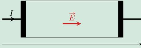
Considérons un conducteur ohmique cylindrique de longueur  $\ell$ , rayon  $a$ , fait d'un matériau de conductivité électrique  $\gamma$ . Une différence de potentiel est imposée aux bornes de l'échantillon, dans lequel apparaît un champ électrique  $\vec{E}$  uniforme, et par suite une densité volumique de courant  $\vec{j}$ .
