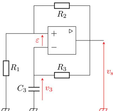
Dans le montage ci-contre, l'ALI idéal fonctionne en régime saturé. On note  $\varepsilon = v_+ - v_-$  la tension différentielle à l'entrée de l'ALI. On suppose qu'à  $t = 0$ , le condensateur  $C_3$  est déchargé et  $\varepsilon > 0$ . On pose
