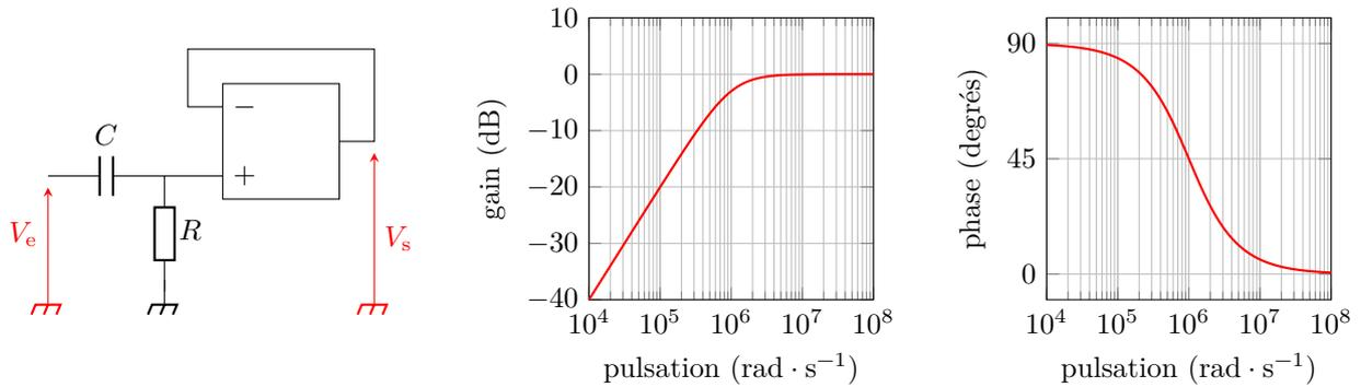
**Figure 6 – Schéma et diagramme de Bode du filtre  $\mathcal{F}$ .**
