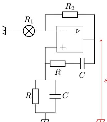
Cet exercice aborde un dispositif permettant d'améliorer la pureté harmonique d'un oscillateur en régulant automatiquement le gain de l'amplificateur. Utilisant une simple lampe à incandescence, cette régulation a été inventée par Bill Hewlett et David Packard dans le garage de ce dernier à la fin des années 1930. On l'imagine ici inclus dans un montage à ALI, ce qui était en fait impossible à l'époque puisque le développement massif des ALI date du début des années 1950.
