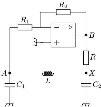
On cherche à déterminer la pulsation et les conditions d'auto-oscillations du montage ci-contre, appelé oscillateur Colpitts.
