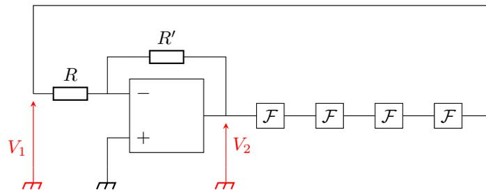
**Figure 7 – Schéma complet de l'oscillateur.**
