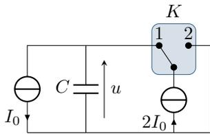
Le condensateur est de capacité  $C = 10 \text{ nF}$ , alimenté par deux sources idéales de courant constant  $I_0 = 1 \text{ mA}$ . La tension  $u$  aux bornes du condensateur est envoyée en entrée d'un comparateur à hystérésis inverseur dont la sortie est  $v = \pm V_s$ . Cette tension de sortie commande l'interrupteur  $K$  :
