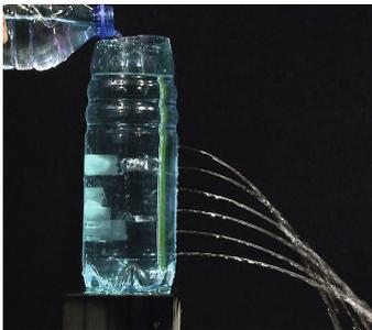
Plus l'orifice est bas, plus la hauteur d'eau qui le surmonte est élevée, plus le jet semble puissant et aller loin, signe que la vitesse à laquelle le fluide s'écoule est d'autant plus élevée.
