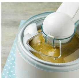
Une sorbetière est une machine permettant de fabriquer des glaces faites maison. La préparation (basiquement fruits, eau et sucre), sortie du réfrigérateur, est versée dans un bol sorti du congélateur. Ce bol contient une solution saline dont la fusion progressive permet de récupérer une grande quantité d'énergie à basse température<sup>2</sup>, et donc de refroidir efficacement la préparation. Un petit moteur fait tourner une pale qui agite le mélange, jusqu'à la prise en glace.
