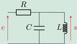
Établir la fonction de transfert du circuit ci-contre, et l'écrire sous forme canonique
