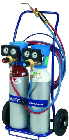
Un chalumeau est un outil employé pour la découpe ou la soudure thermique de pièces de métal. La source de chaleur est obtenue par la combustion d'un mélange de gaz. Dans le cas d'un chalumeau oxyacétylénique, le gaz utilisé est l'acétylène C<sub>2</sub>H<sub>2</sub>, dont la combustion dégage une énergie importante du fait de la triple liaison carbone-carbone et de l'efficacité de l'oxycombustion. La température de la flamme ainsi produite peut dépasser 3100 °C.
