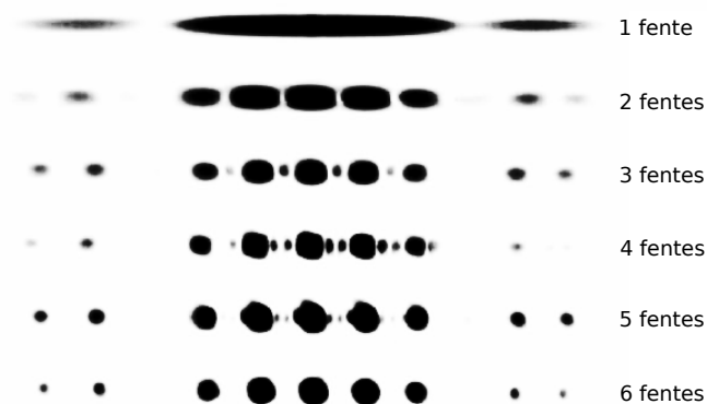
Figure 10 – Figure obtenue par passage d'un laser au travers de 1 à 6 fentes. Plus le nombre de fentes est élevé, plus les tâches brillantes sont lumineuses, ce que la figure ne permet pas de montrer.
