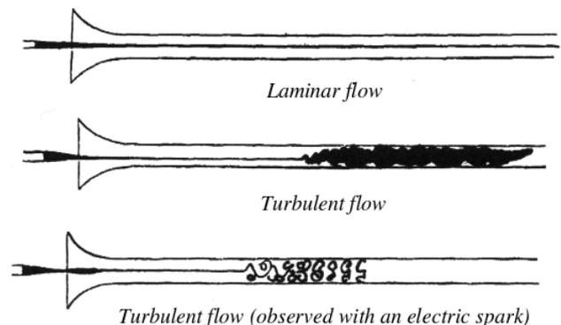
Figure 1 – Travaux expérimentaux d'Osborne Reynolds.
