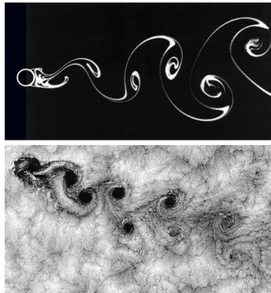
**Figure 2 – Allées de von Karman.** En haut, image obtenue en laboratoire par écoulement d'une huile visqueuse autour d'un cylindre ; en bas image obtenue par observation satellite des nuages autour d'un volcan.
