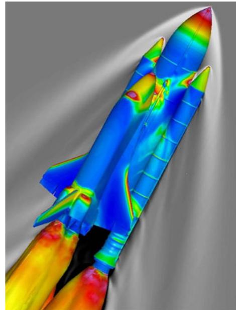
**Figure 4 – Simulation de l'écoulement d'air autour d'une navette spatiale.** Le code couleur indique la pression locale.
