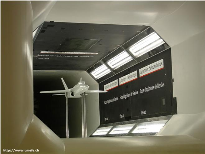
**Figure 3 – Essai aérodynamique d'un avion à réaction.**
