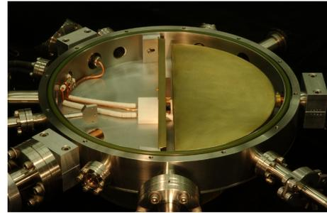
**Figure 1 – Étude d'un cyclotron.** Schéma de principe et photo du cyclotron de l'université de Rutgers, qui mesure une trentaine de centimètres de diamètre.
