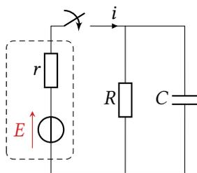
Considérons le circuit ci-contre, dans lequel un générateur est branché en parallèle d'une cellule RC à l'instant  $t = 0$ . Le générateur est décrit par son modèle de Thévenin, de fém  $E$  constante et de résistance interne  $r$ .
