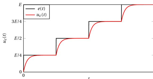
Un condensateur est chargé via un circuit RC série jusqu'à une tension  $E$  par paliers successifs d'amplitude  $E/N$ . On suppose chaque palier suffisamment long pour que la charge soit complète.
