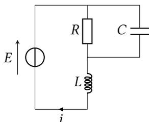
Considérons le circuit représenté ci-contre, où le condensateur est initialement déchargé. Le générateur fournit un échelon de tension, en passant de 0 à  $E$  à  $t = 0$ .
