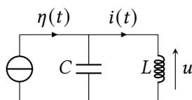
Dans le circuit ci-contre, le générateur supposé idéal est brusquement éteint,  $\eta(t)$  passant instantanément de  $I_0$  à 0 à l'instant  $t = 0$ . On appelle  $\mathcal{E}_{\text{tot}} = \mathcal{E}_C + \mathcal{E}_L$  l'énergie électrique totale stockée dans le condensateur et la bobine.
