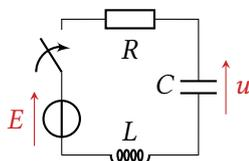
**E3+M2.3** - Établir l'équation différentielle vérifiée par la tension  $u$  pour  $t > 0$  et l'écrire sous forme canonique. Donner la forme de ses solutions en fonction de la valeur de  $Q$  et des racines du polynôme caractéristique (que l'on ne résoudra pas explicitement).
