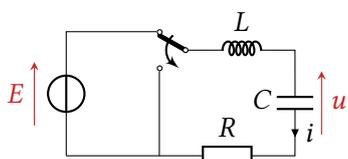
L'interrupteur du circuit ci-contre est basculé à l'instant  $t = 0$ , et l'observation de la tension  $u$  à l'oscilloscope montre un régime pseudo-périodique.
