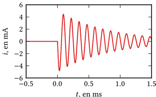
La courbe ci-contre représente le courant mesuré dans un circuit formé d'une bobine et d'un condensateur montés en série avec un générateur imposant un échelon de tension. On admet que la bobine est très bien décrite par une bobine idéale, mais pas le générateur, de résistance interne  $r = 50 \Omega$ .
