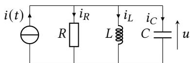
À l'instant  $t = 0$ , le générateur de courant impose que  $i(t)$  passe de 0 à  $I_0 = 10 \text{ mA}$ . Les composants sont choisis tels que  $R = 50 \Omega$ ,  $C = 400 \text{ nF}$  et  $L = 100 \text{ mH}$ .
