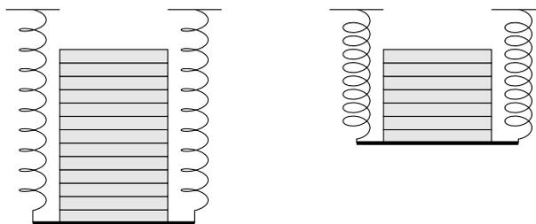
Figure 2 – Chariot à niveau constant d'un distributeur de plateaux.
