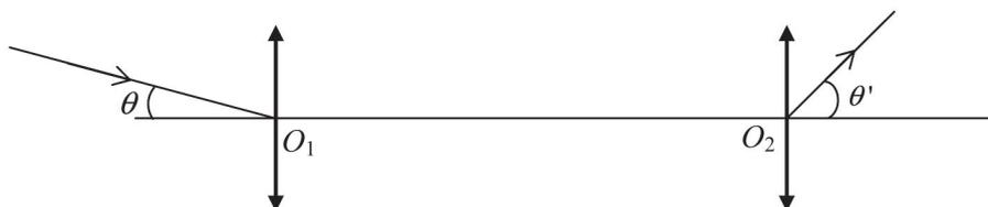
Figure 6 – Schéma d'une lunette astronomique.
