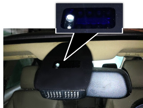
Figure 1 – Principe de fonctionnement d'un détecteur de pluie.
