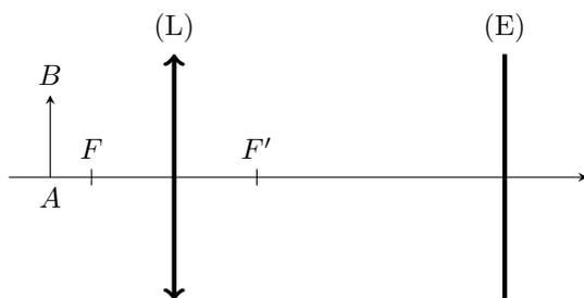
Dans une salle de cinéma, on lit, à l'aide d'un projecteur, une pellicule  $AB$  de largeur  $b$  sur un écran (E) de largeur  $\ell$ . On modélise le projecteur par une source lumineuse et une lentille convergente (L) de focale  $f'$  suivant le schéma ci-contre, qui n'est pas représenté à l'échelle. On note  $d$  la distance de la pellicule à l'objectif et  $D$  celle de la pellicule à l'écran.
