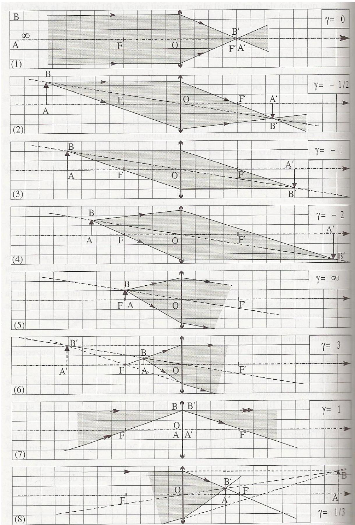
Figure 2 – Constructions pour une lentille convergente.
