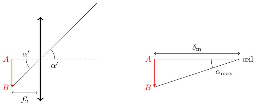
**Figure 7 – Définition du grossissement commercial.** L’objet  $AB$  est le même sur les deux schémas.
