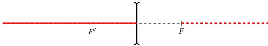
**Figure 5 – Position des objets permettant de former une image virtuelle par une lentille divergente.** Les objets placés avant le centre optique  $O$  sont réels (trait plein), ceux placés après sont virtuels (trait pointillé).
