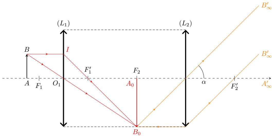
**Figure 8 – Marche des rayons dans un microscope.**
