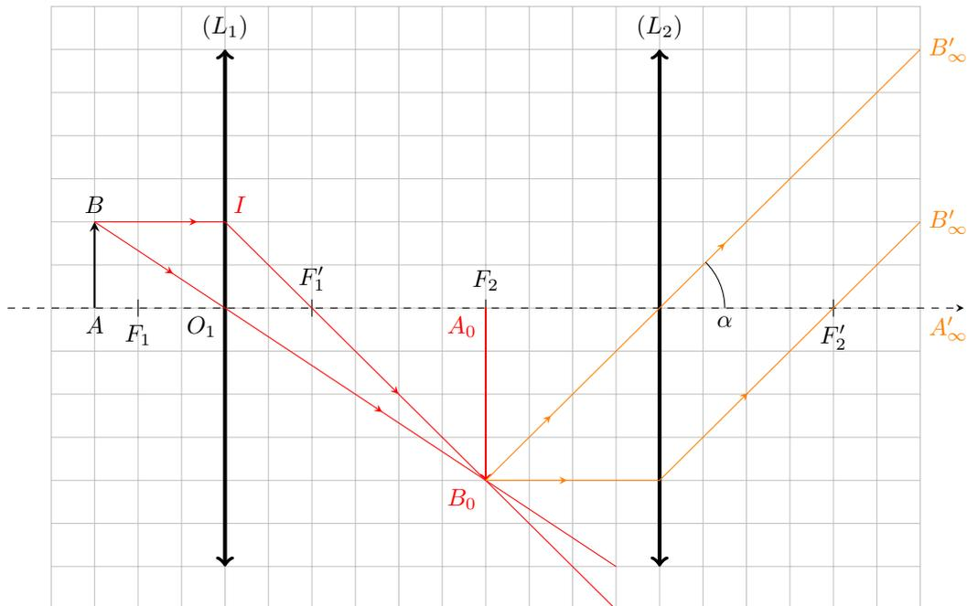
**Figure 6 – Formation de l’image au travers d’un microscope.** Les rayons servant à construire l’image intermédiaire  $A_0B_0$ , image de  $AB$  par la lentille  $L_1$ , sont représentés en rouge. Les rayons servant à construire l’image finale  $A'B'$ , image de  $A_0B_0$  par la lentille  $L_2$  sont représentés en orange. Plusieurs notations utiles à la suite de l’exercice sont introduites sur ce schéma. Version en couleur sur le site de la classe.
