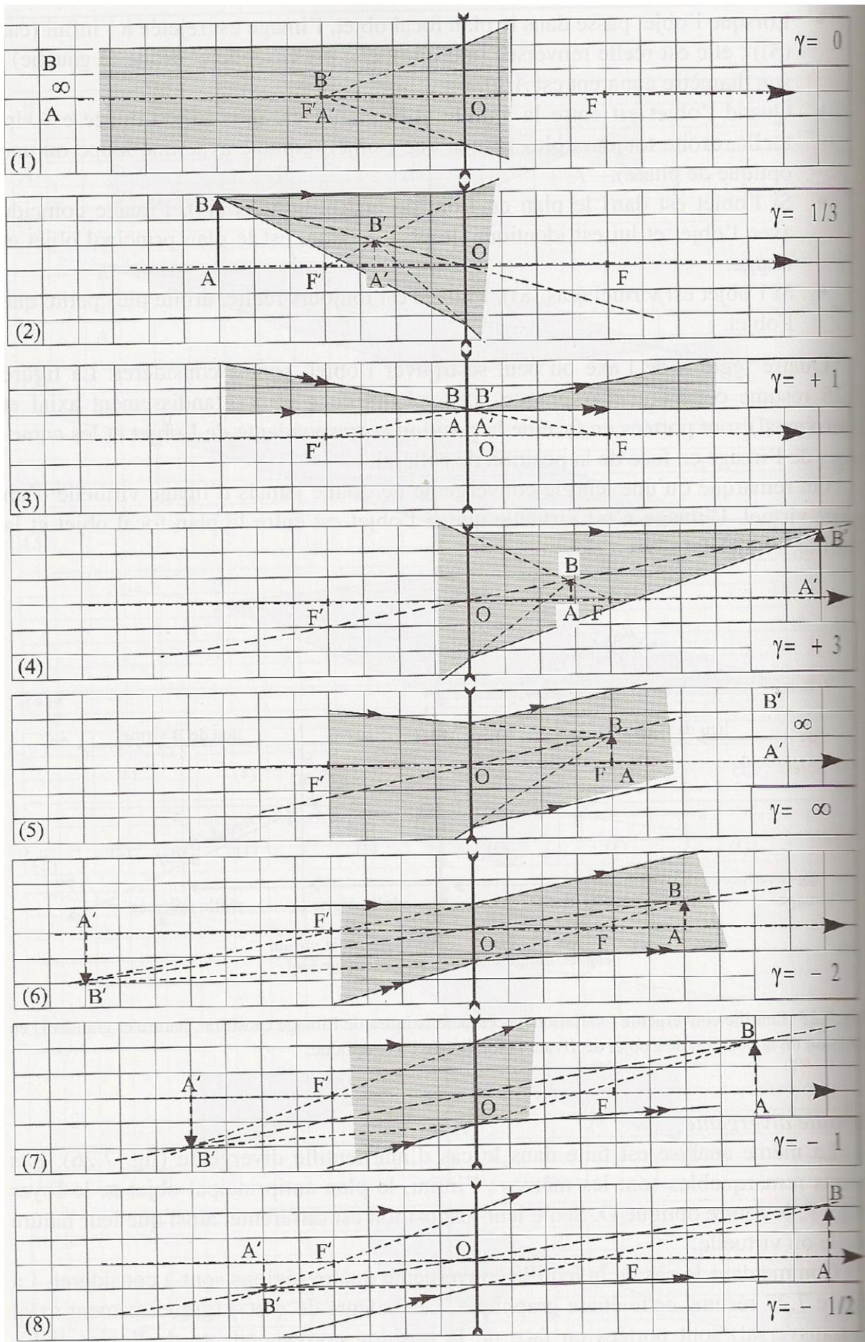
Figure 3 – Constructions pour une lentille divergente.
