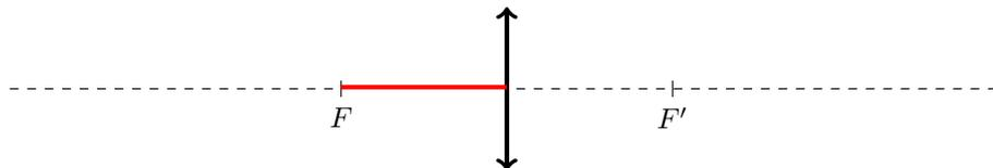
**Figure 4 – Position des objets permettant de former une image réelle par une lentille convergente.** Les objets placés avant le centre optique  $O$  sont réels (trait plein), ceux placés après sont virtuels (trait pointillé).
