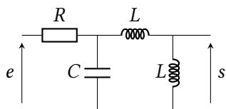
Le filtre de Hartley, représenté ci-contre, a été très utilisé aux débuts de la radio-télégraphie, dans les années 1910-1920. Sa structure à deux bobines donne plus de latitude de réglage de l'impédance d'entrée et de sortie du filtre qu'un circuit RLC classique, ce qui permet de l'intégrer plus facilement à un circuit plus élaboré. Dans cet exercice, le filtre est considéré en sortie ouverte.
