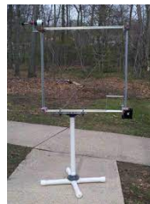
Figure 1 – Antenne cadre. Gauche : deux exemples d'antennes utilisables en radiocommunication. Droite : schéma de principe.
