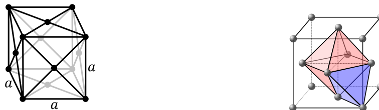
Figure 2 – Structure CFC. Gauche : Schéma de la maille. Droite : Sites interstitiels, octaédrique en rouge et tétraédrique en bleu. Figures extraites de Wikipédia. Version couleur sur le site de la classe.
