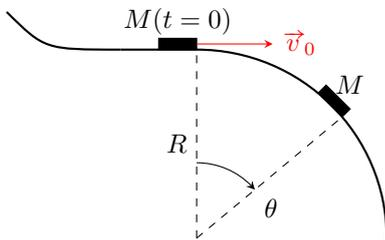
Une luge, modélisée par un point matériel  $M$  de masse  $m$ , arrive sur une bosse à profil circulaire avec une vitesse horizontale  $\vec{v}_0$ . Tant que la luge suit ce profil, sa trajectoire est circulaire de rayon  $R$  et sa position est repérée par l'angle  $\theta$ . On néglige tout frottement.
