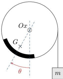
Un cylindre d'axe  $(Ox)$  et de rayon  $a$  tourne librement. Un dépôt sur la paroi du cylindre forme un balourd de masse  $M$  et centre de masse  $G$ . On pose  $OG = d$ . Le moment d'inertie par rapport à l'axe de rotation vaut  $J = Ma^2$ . On néglige la masse propre et l'inertie du cylindre devant celles du balourd. Une masse  $m$  est accrochée à un fil inextensible de masse nulle enroulé autour du cylindre.
